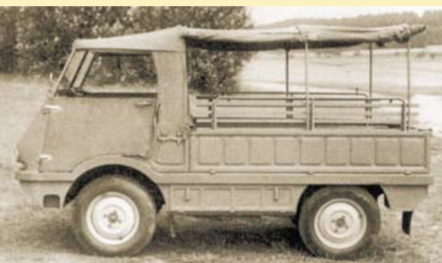
Skoda 998 Agromobile — прототип утилитарного развозного грузовичка для сельскохозяйственных работ имел мягкий тканевый верх и откидные борты для удобства погрузочно-разгрузочных работ (1962 г.).
