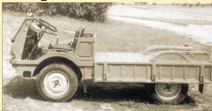
Skoda 998 Agromobile — прототип утилитарного развозного грузовичка для сельскохозяйственных работ имел мягкий тканевый верх и откидные борты для удобства погрузочно-разгрузочных работ (1962 г.).
