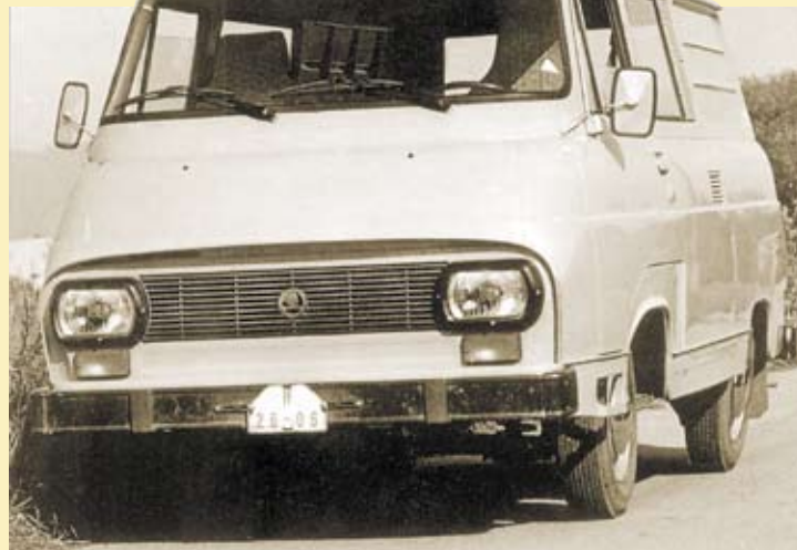
Одна из поздних версий Skoda 1203 (1981 г.) с кузовом комби отличалась светотехникой, облицовкой радиатора и рядом других деталей.
